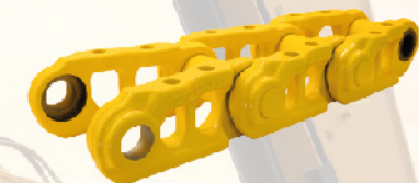
Cadenas: Selladas, No Selladas, Engrasada y Lubricada
